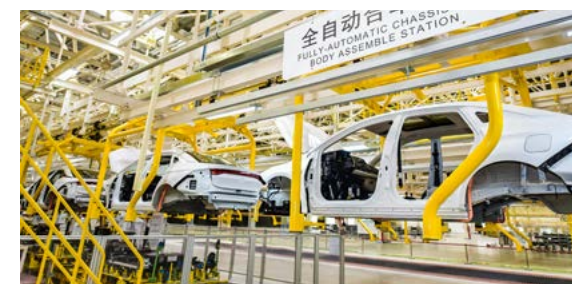
新能源汽车制造企业正在进行全自动合车
